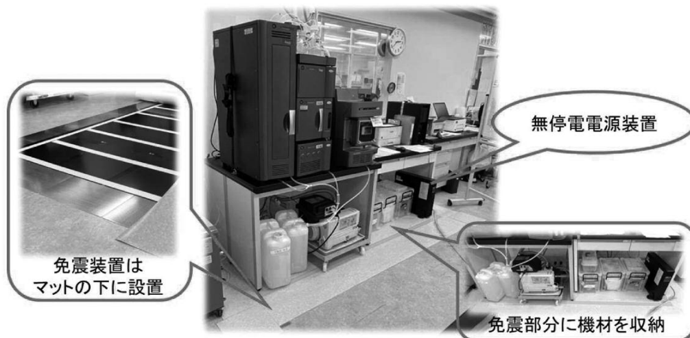
図2. 大型測定機器に設置した免震装置
